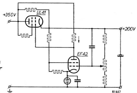
Fig. 5. Stabilisierung
