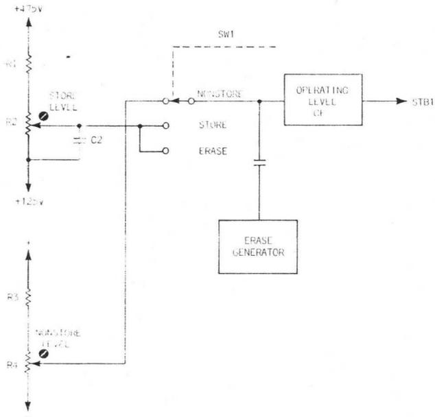
Fig. 8-2. Store, nonstore voltages circuit.
