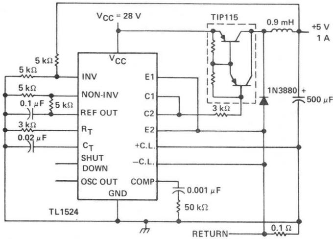
FIGURE 14—SINGLE-ENDED LC CIRCUIT
