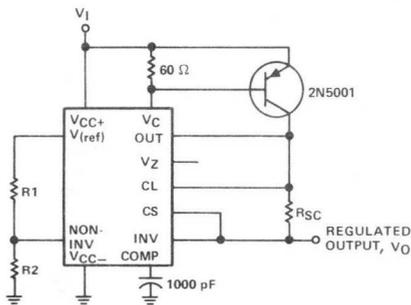
FIGURE 5—POSITIVE-VOLTAGE REGULATOR
