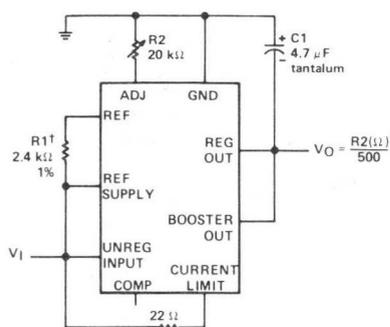
FIGURE 1—BASIC REGULATOR CIRCUIT
