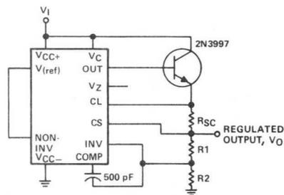
FIGURE 4—POSITIVE-VOLTAGE REGULATOR
