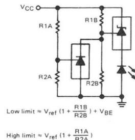
FIGURE 15—V<sub>CC</sub> MONITOR
