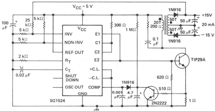
FIGURE 13 — FLYBACK CONVERTER CIRCUIT
