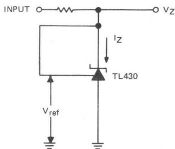
FIGURE 1—TEST CIRCUIT FOR V<sub>Z</sub> = V<sub>ref</sub>
